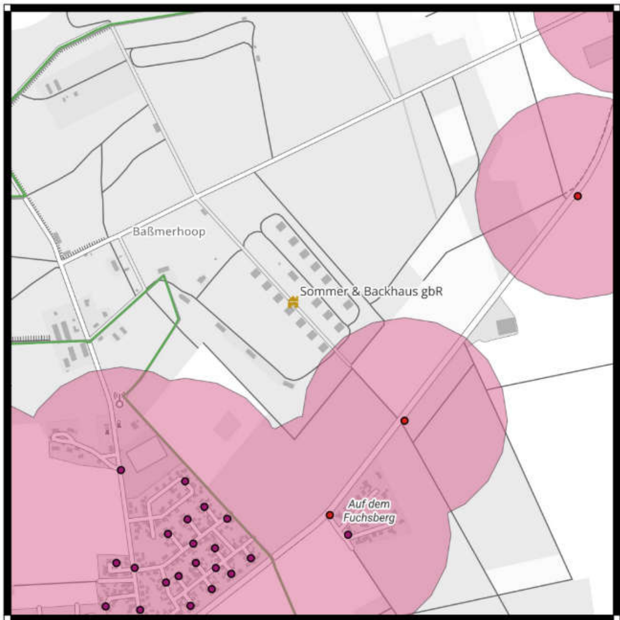
Abbildung 26: Löschwasserentnahmestellen ehemalige Munitionsanstalt
